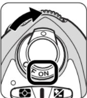
**2** SB-400およびカメラの電源をONにします。
